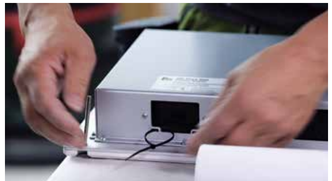
Kabelbinder für Zugentlastung anbringen.
