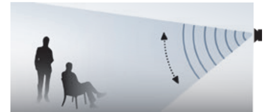
DE Plan 800 AIArray, Wandeinbau mit einstellbarem Abstrahlwinkel
