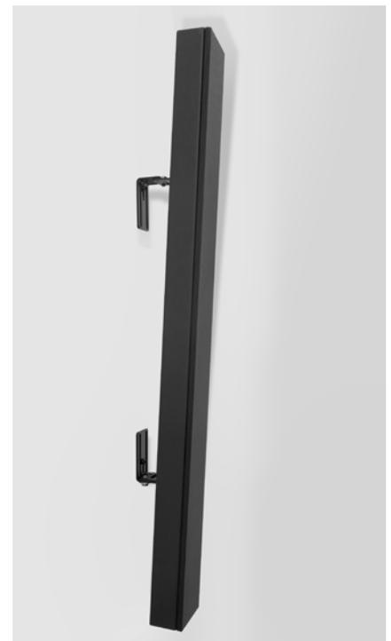
Die L-Winkel A werden mit den mitgelieferten Schrauben an der Lautsprecher-rückseite befestigt. (Innensechskantschrauben M 6 × 16 + Tellerfedern)
