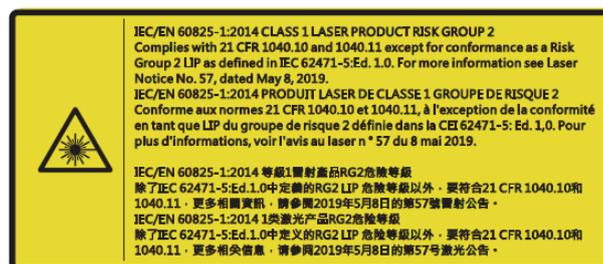
Les mises en garde relatives au laser ci-dessus sont situés au dessous de cet appareil.
